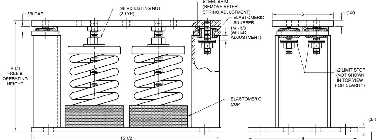
**MODEL M2S-3C SEISMICALLY RESTRAINED VIBRATION ISOLATOR FOR 3" DEFLECTION**
